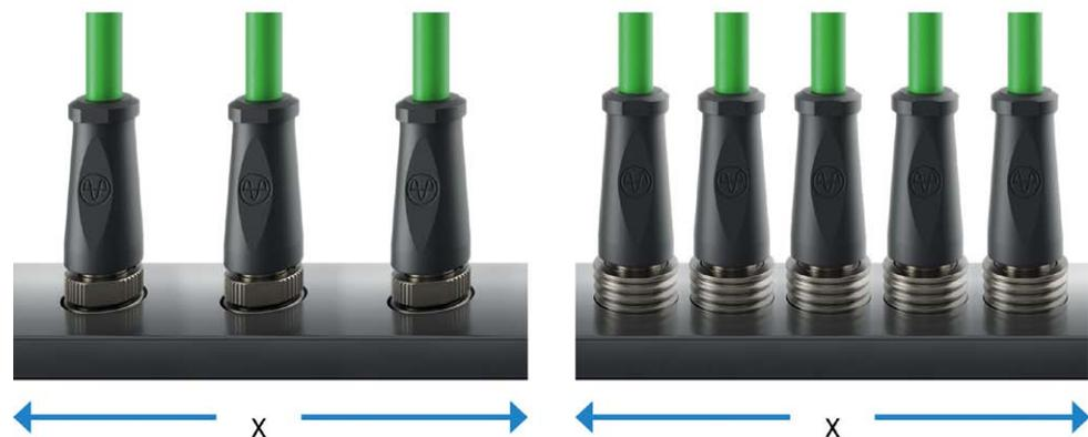
M12-Push-Pull-Steckverbinder mit Innenverriegelung erlauben ein platzsparendes Design-In. Die Push-Pull-Handhabung ist so einfach, dass die Steckplätze viel dichter nebeneinander sein können als beim M12 mit Schraubverriegelung
